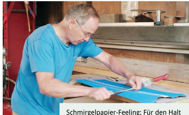
Schmirgelpapier-Feeling: Für den Halt erhält das Board ein blaues Griptape
