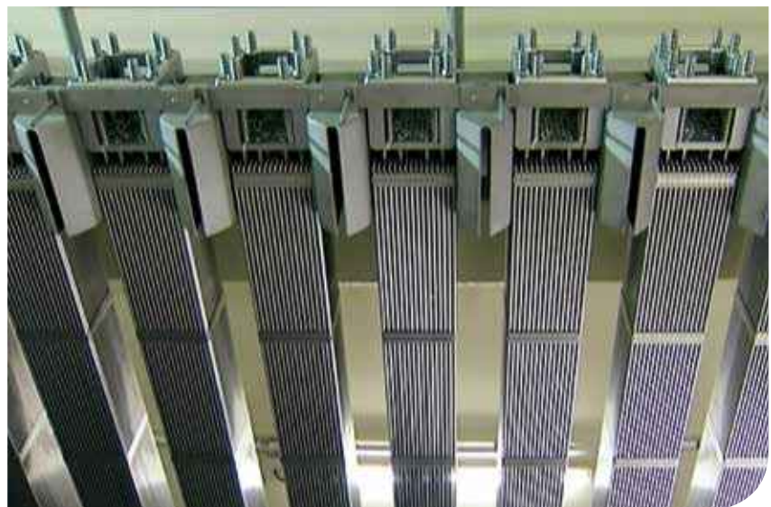
Brennelemente, deren Stäbe den Kernbrennstoff enthalten
